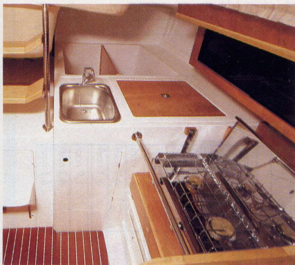
La cucina si sviluppa a L e dispone di ghiacciaia a pozzetto da 40 lt, lavello inox e fornello cardanico a due fuochi. Dietro si può vedere il vano doppio per le cerate bagnate.
