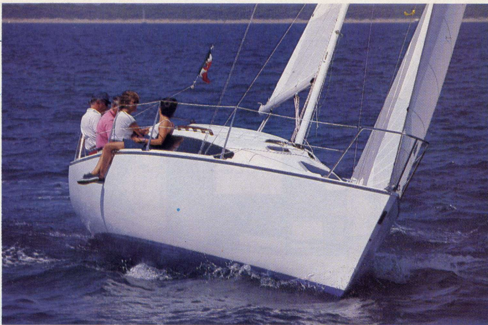
Le sezioni di carena piuttosto tonde mantengono la giusta simmetria dei volumi sotto sbandamento, esaltando l'equilibrio al timone, mentre il ridotto sviluppo della superficie bagnata e il piano velico allungato garantiscono buone prestazioni con vento leggero.
