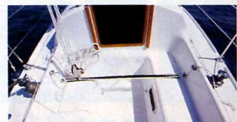
Il pozzetto del Nytec 28 è ampio, il trasto della randa è però posizionato al centro.
