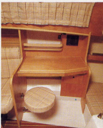
Il carteggio posto a murata consta di un sedile a scomparsa, uno stipetto e un vano libreria. Ampio il piano di cm 90x46.
